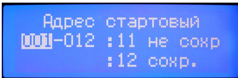
Рисунок 6: Установка стартового адреса
