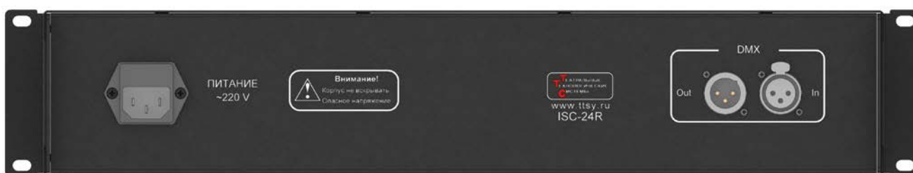
Рисунок 1: Задняя панель пульта управления DMX-свитчерами. Основные элементы:
