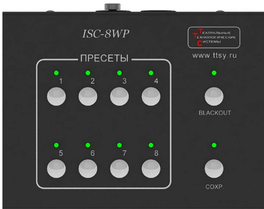
Рисунок 2: Передняя панель дополнительного 8-пресетного пульта управления DMX-свитчерами
