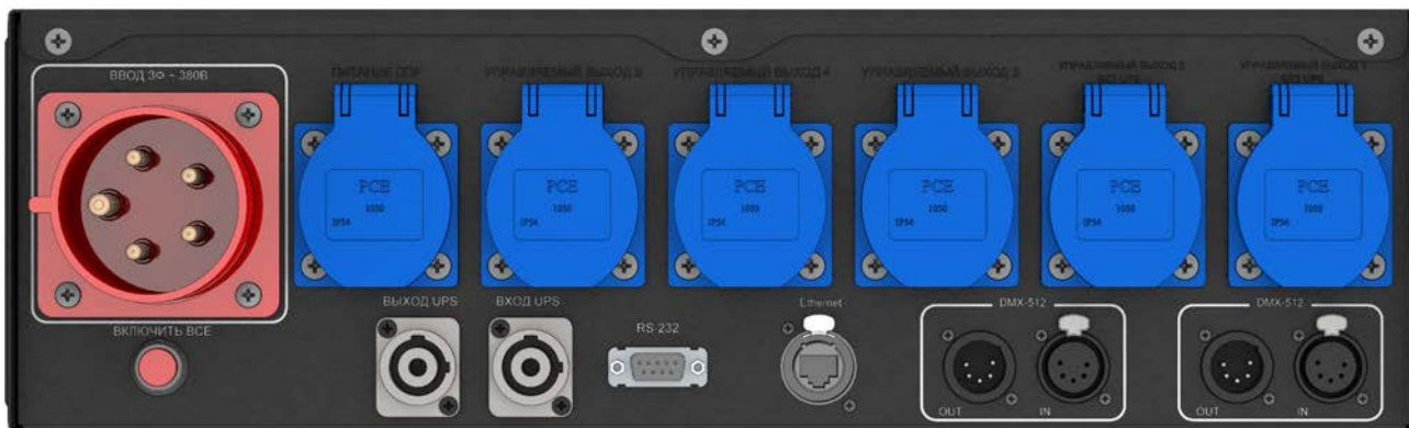
Рисунок 1: Задняя панель блока распределения питания для ШСА. Основные элементы:
